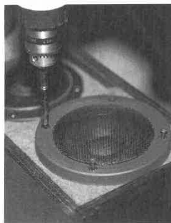
●ウーファ・ユニットは、前回よりもさらに4mm前進、ネジは締め過ぎないように。
