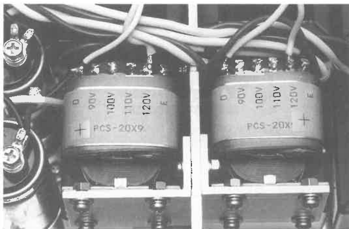
●イコライザの電源に使ったシンコーのPcS-20 X 9。フラット・アンプにはジャンクのEIコア形を使用。どちらでも可
