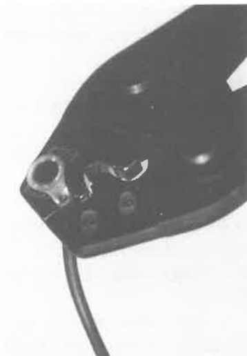
●ケミコンのリード線はすべて専用カシメ工具を使って端子を仕上げる
