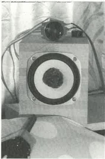
<第26図> みつともなくもメタル・キャップをフェルトで覆われた FF 165 N。これでも“メタル・キャップ”の鳴きが聴こえる。
