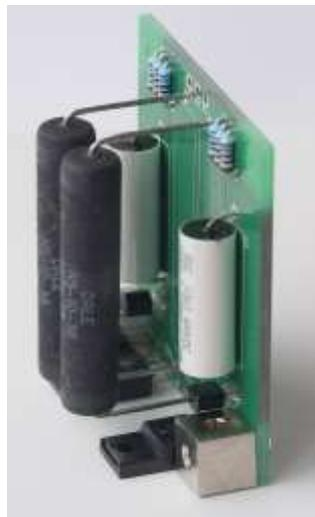
図5 垂直取り付け時の組み立て方
