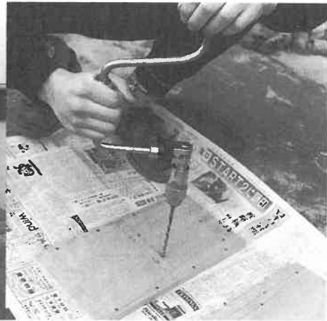
〈写真3〉 木ネジ用の穴加工。
