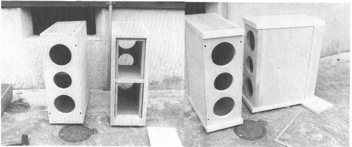
●組立てが終わったエンクロージャ。右はフランジをつけたところ。
