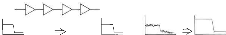
(a) デジタル回路では何段通過しても信号の意味は変わらない
