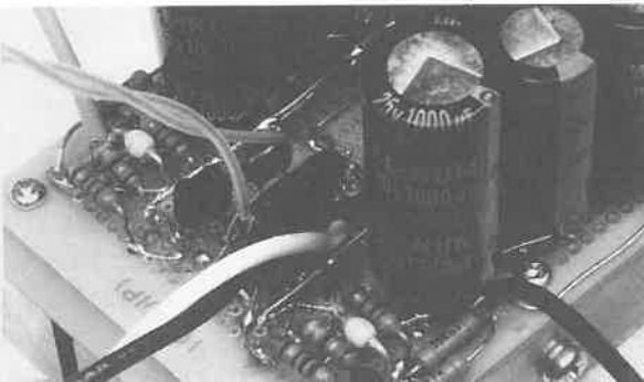
《写真 H》入力ラインは R_{10} の足にハンダづけする
