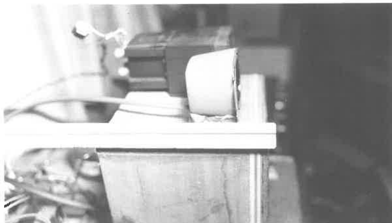
●物差しを当てて慎重にツイータを動かしながら測定する。
