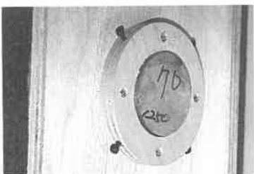
《写真E》ウーファのデッド・マスの支持法しか観測されません。よくありません。
