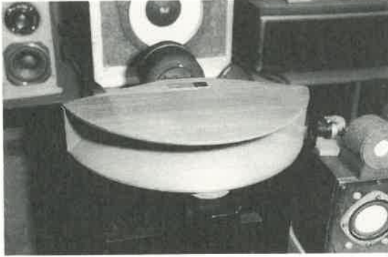
パイオニア PD801 ドライバ+フォステクス H420 ホーンの組み合わせ
