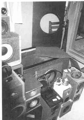
●ウーファ・ボックスはフェルトをかぶせて穴あき板をのせるだけの状態
