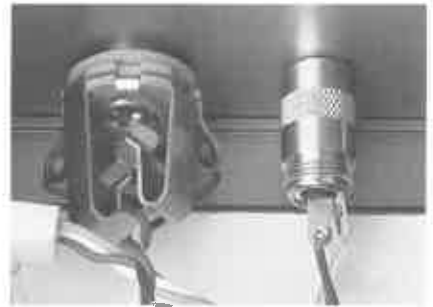
《写真E》ヘッドフォン・ジャックへの配線
