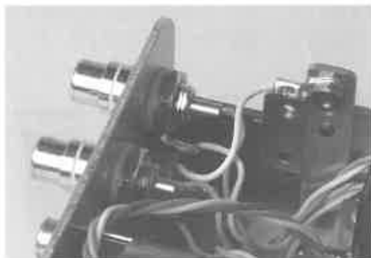
《写真G》 ケースへは、シャーシ取り付け金具を使ってグラウンド・アースをとる
