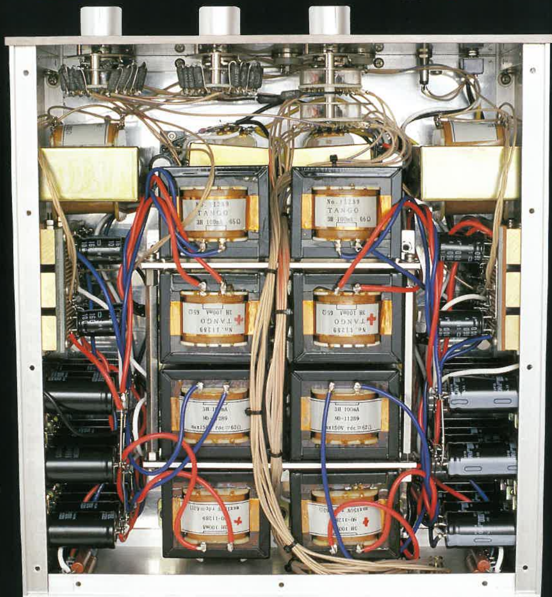
●各段ごとに独立電源方式を採用している。PTはTANGOの特注品。
